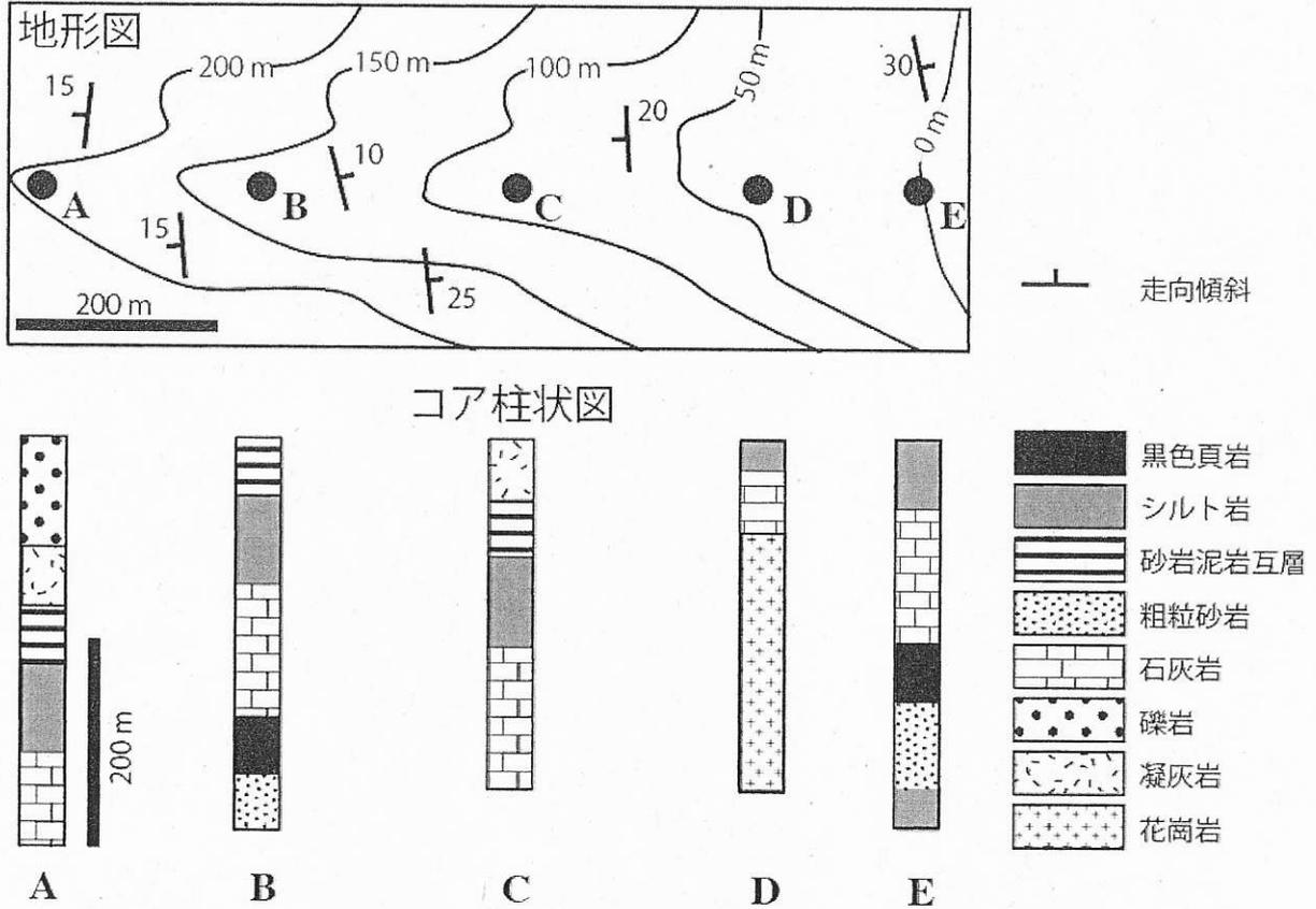
図3 Z地域の地形図と掘削コアから作成した柱状図
