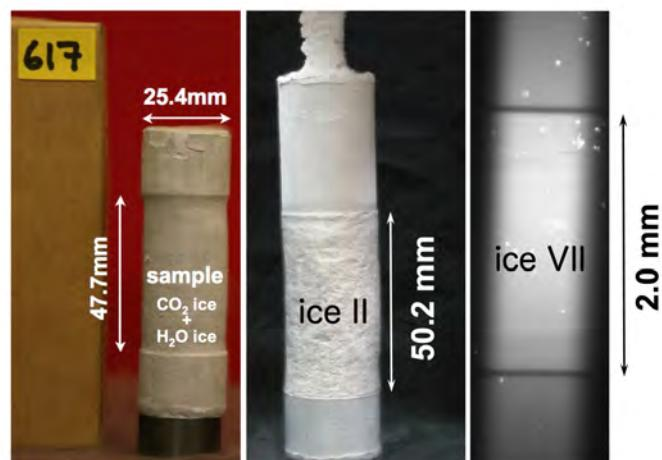
図5 惑星氷の高圧下での変形実験
