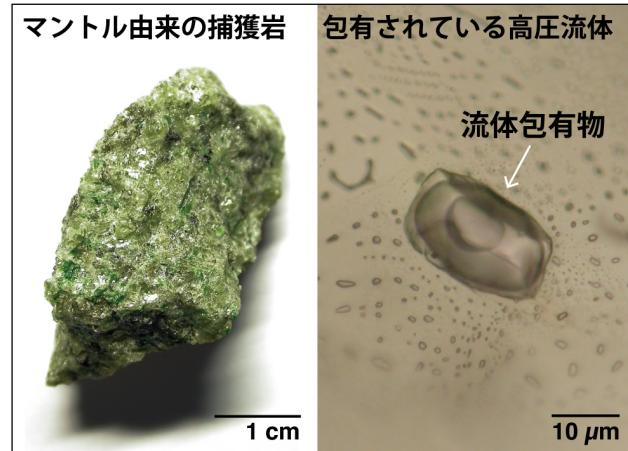
**[極小流体に特化した同位体分析法の開発]** マントル由来の岩石に包有されている流体は、地球の表層と内部をつなぐ循環系を担う物質です。この小さな包有物一つひとつの起源を探るため、極小流体の同位体比分析に特化した顕微ラマン分光分析装置の開発を進めています。これにより  $\text{CO}_2$  流体や  $\text{N}_2$  流体の炭素や窒素の同位体比を精度良く決めることが可能になってきました。この手法を流体包有物に適用すれば、地球内部の物質循環系が見えてくるでしょう。
