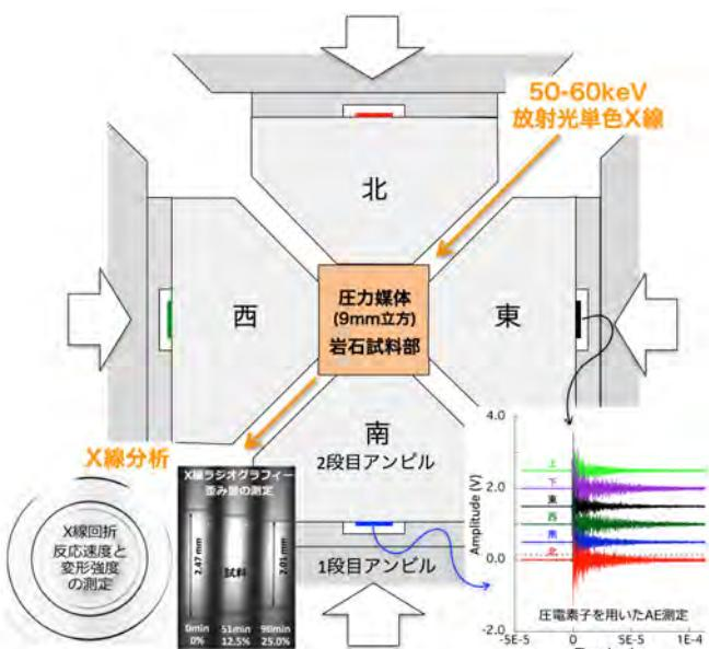
図4 放射光X線を使って高温高圧下で岩石の相転移や変形破壊挙動をその場観察できる実験装置
